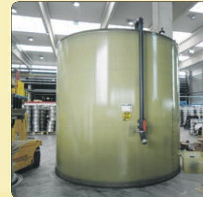
Dank der Vor-Ort-Montage sind auch bei schwierigen Zugangsbedingungen große Lagerkapazitäten möglich. Bei Durchmessern bis 4,00 m und Höhen bis 10,0 m kann praktisch jeder Raum optimal genutzt werden.
