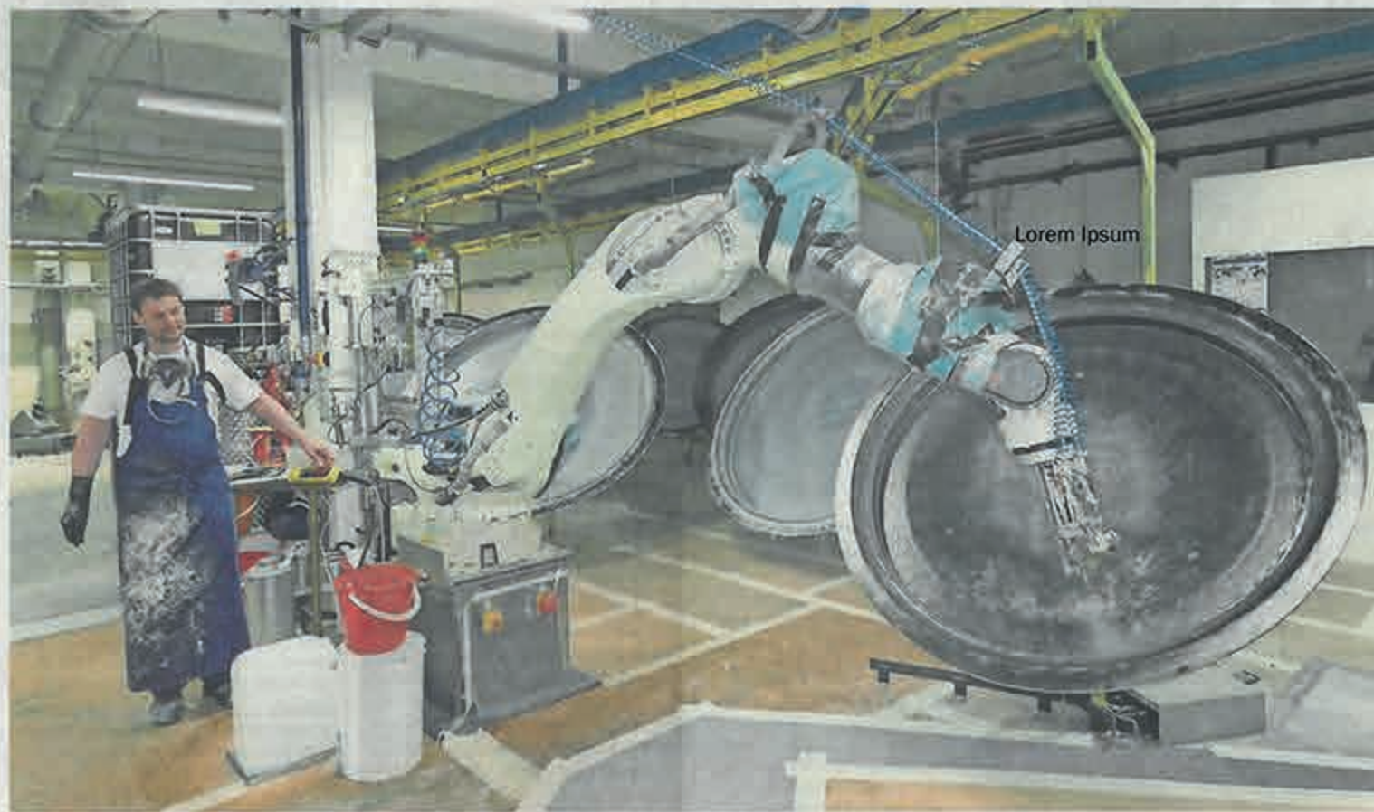
Alexander Steglich und der Sprühroboter sind für das Beschichten der Deckel und Böden mit einem Faser-Harz-Gemisch verantwortlich. FOTO: UWE MENSCHNER
